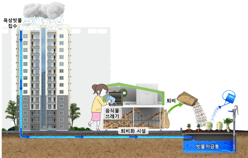
[그림 5-21] 빗물과 음식물쓰레기를 활용한 자원순환형 생태텃밭의 개념도
